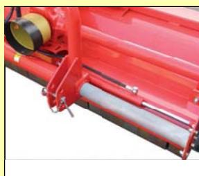
Spostamento laterale idraulico di 470 mm per superare agevolmente gli ostacoli
