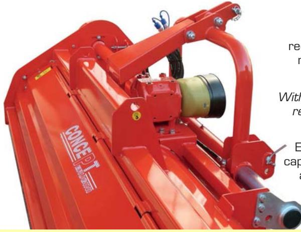
Con spostamento idraulico di serie, cofano regolabile e rullo posteriore, la trinciatrice MT rappresenta la soluzione più versatile per un gravoso uso professionale
